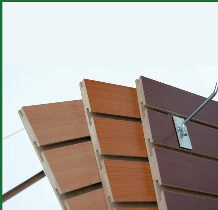
Para cortar los tableros, las ranuras deben estar ubicadas cara arriba o cara abajo dependiendo del tipo de sierra a ser usada. Si utiliza una sierra montada en una mesa (sierra horizontal), las ranuras deben estar cara arriba. Si usa una sierra manual, las ranuras deben estar cara abajo. El objetivo de esto es lograr un mejor acabado en el corte de la sierra.
